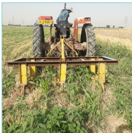
▲ شکل ۱۱- کنترل مکانیکی علف‌های هرز در کشت مستقیم، کاهش ترافیک و فشردگی خاک
