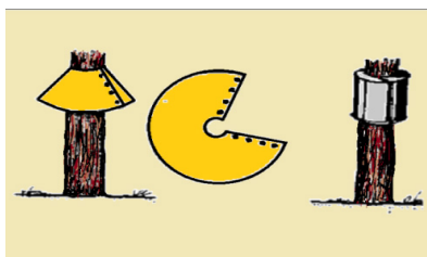
شکل ۲۲- نصب ورقه فلزی در انبارهایی که روی ستون بنا شده‌اند جهت جلوگیری از ورود موش
