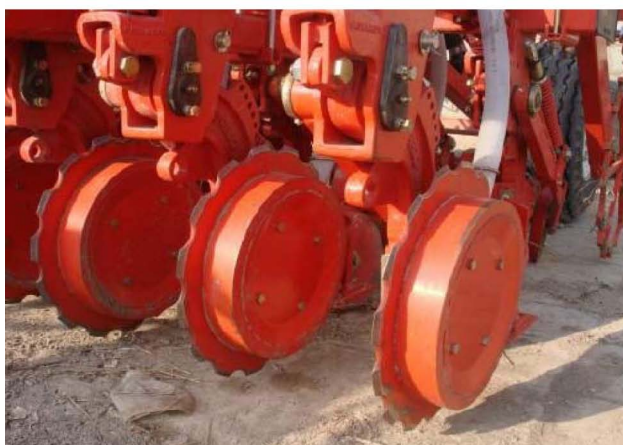
شکل ۱۹- بذر کار کشت مستقیم در بقایای گیاهی و شیار باز کن بشقابی کنگره دار
