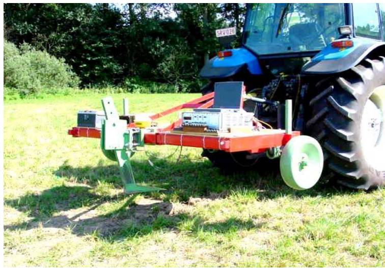
شکل ۱۰ - زیرشکن مجهز شده به مبدل حلقوی هشت وجهی
