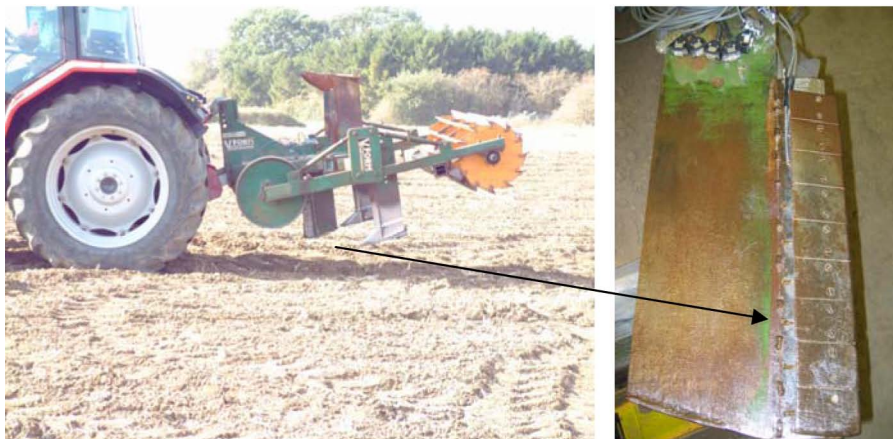
شکل ۸- حسگر پروفیل فشردگی خاک (راست) و زیرشکن مجهز شده به حسگر (چپ)
