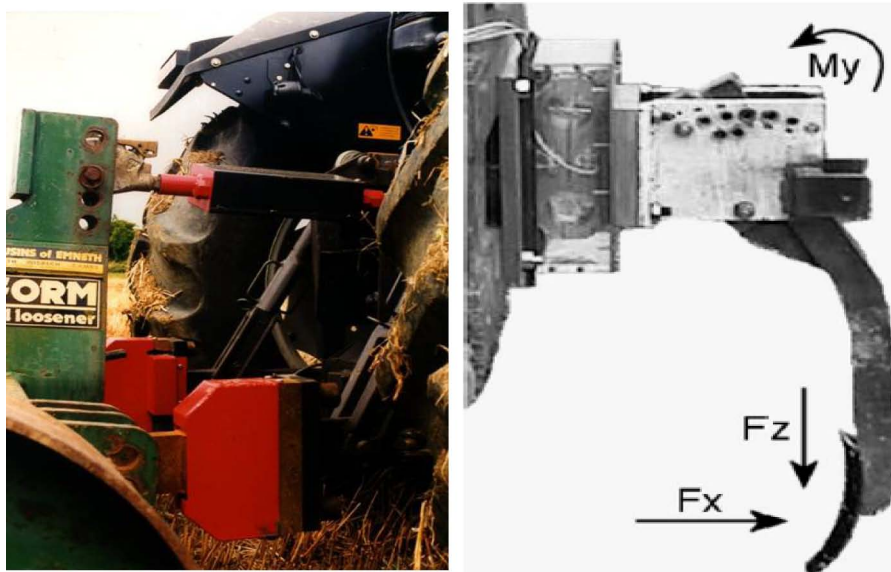
شکل ۹ - عامل خاک ورز منضم شده به مبدل حلقوی هشت وجهی (راست) و بازوهای پایینی مجهز شده به مبدل‌های حلقوی هشت وجهی و بازوی بالایی مجهز شده به کرنش‌سنج (چپ)
