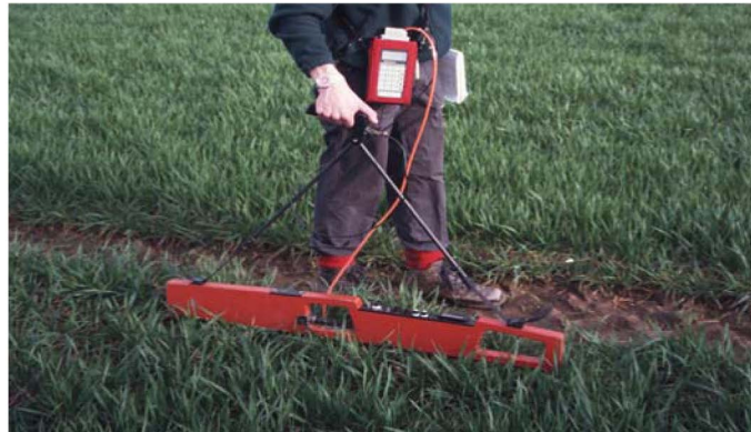
شکل ۱۲- عملیات القاء الکترومغناطیس بوسیله EMI 38
