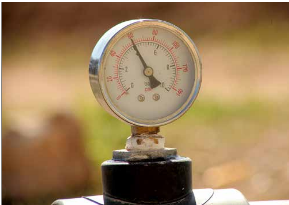
تصویر ۶ - فشار سنج استفاده شده در سامانه آبیاری بارانی
