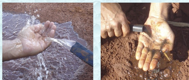
شکل ۷- کنترل فیزیکی آب در انتهای لاترال
