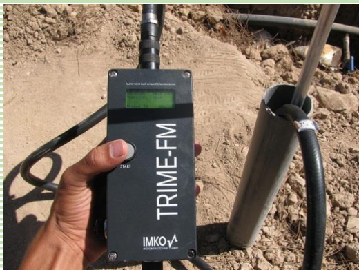
شکل ۳- نحوه‌ی اندازه‌گیری رطوبت با دستگاه رطوبت سنج ترایم
