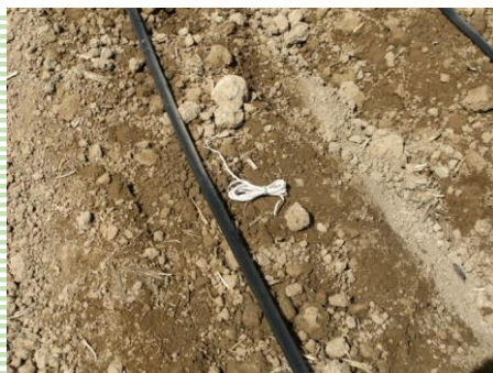
شکل ۴- بلوک گچی نصب شده در یک مزرعه ذرت
