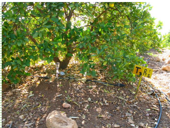
شکل ۶- تانسیومتر نصب شده در کنار درخت پرتقال
