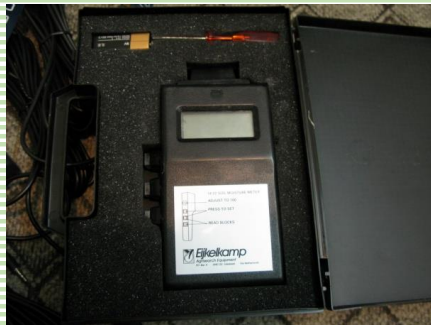
شکل ۳- دستگاه قرائت گر بلوک گچی
