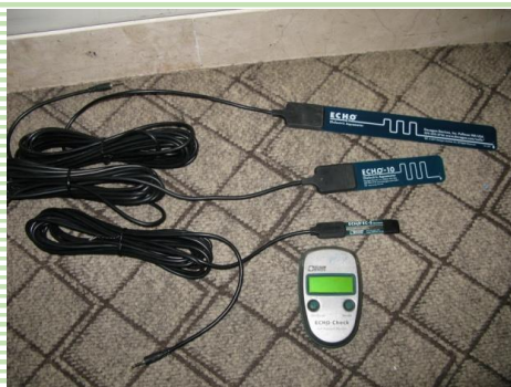
شکل ۱۰- دستگاه رطوبت سنج خاک ECH2O
