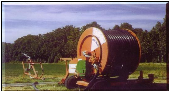
شکل ۱۱ : دستگاه آبیاری بارانی قرقره ای
