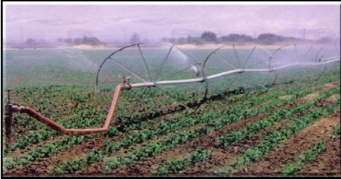
شکل ۱۰ : دستگاه آبیاری بارانی غلطان (ویل موو)
