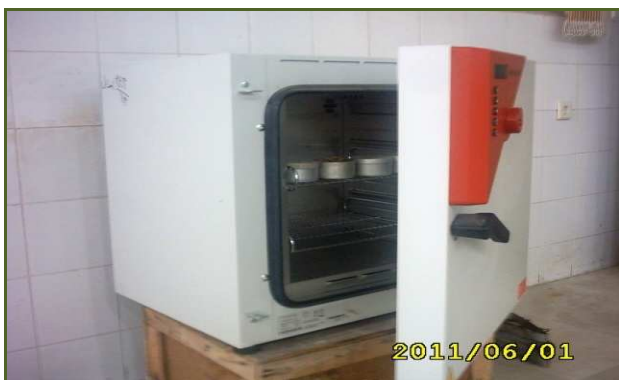
شکل ۶- آون (اتوکلاو) جهت خشک کردن خاک
