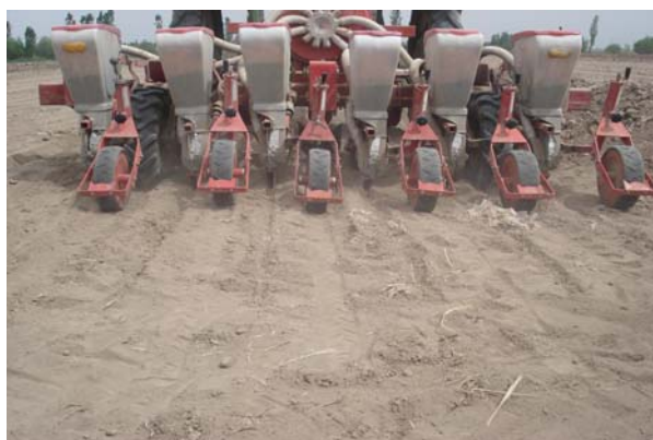
شکل ۱۰- دستگاه بذرکار پنوماتیک چغندر قند
