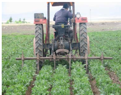
شکل ۱۳- عملیات زدن کولتیواتور در چغندر قند
