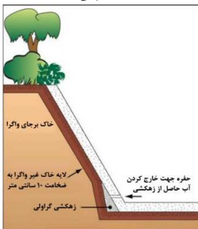
شکل ۲۲-د) پوشش دادن دیواره آبکند با سازه سخت
