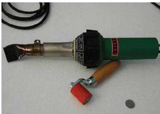
شکل ۱۷- دستگاه جوش پلاستیک (مناسب برای داخل جعبه)
