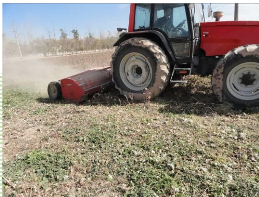
شکل ۴- ساقه خرد کن پشت تراکتوری در حال خرد کردن بقایای پنبه
