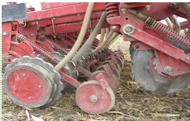
شکل ۲- شیاربازکن‌ها، چرخ‌های فشار دهنده و فنرهای اعمال فشار بر شیاربازکن‌ها در خطی‌کار کشت مستقیم
