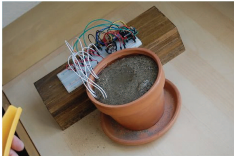
شکل ۷: واسنجی بلوک گچی با خاک تهیه شده از محلی که باید در آن نصب شود
