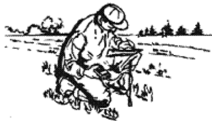
شکل ۳: کارگذاری بلوک گچی در خاک و قرائت رطوبت به صورت درجا در مزرعه
