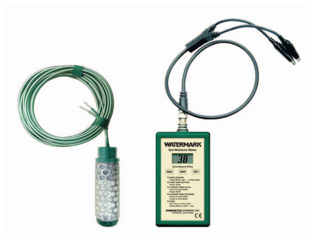
شکل ۲: نمونه‌ای از بلوک گچی به همراه دستگاه اندازه‌گیری مخصوص آن
