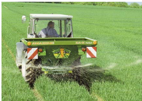
شکل ۶- دو نمونه کودپاش سانتریفیوژ
