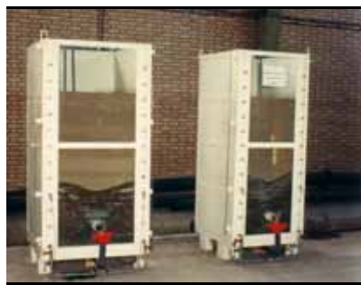
شکل ۱۰ - مدل‌های فیزیکی آب و خاک جهت آزمون لوله و پوشش زهکشی
