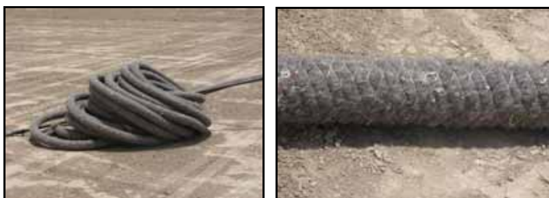
شکل ۸ - پوشش PLM ساخته شده از الیاف ضایعاتی پلی پروپیلن (PP-450)
