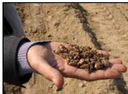
شکل ۳- پوشش معدنی در حال استفاده در یک پروژه زهکشی زیرزمینی در خوزستان شکل ۴ - نحوه لوله‌گذاری و کاربرد پوشش معدنی با استفاده از ترنچر
