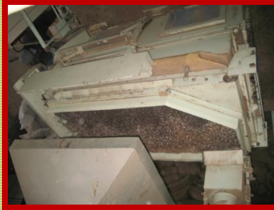
شکل ۱- دستگاه بوجاری بذر پنبه
