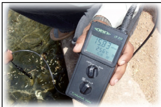
شکل ۳- تعیین هدایت الکتریکی به وسیله شوری‌سنج قابل حمل
