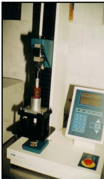
شکل ۸ - اندازه‌گیری بافت کشمش
