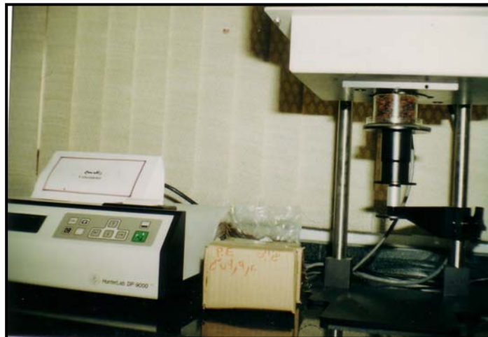
شکل ۹ - اندازه‌گیری رنگ کشمش
