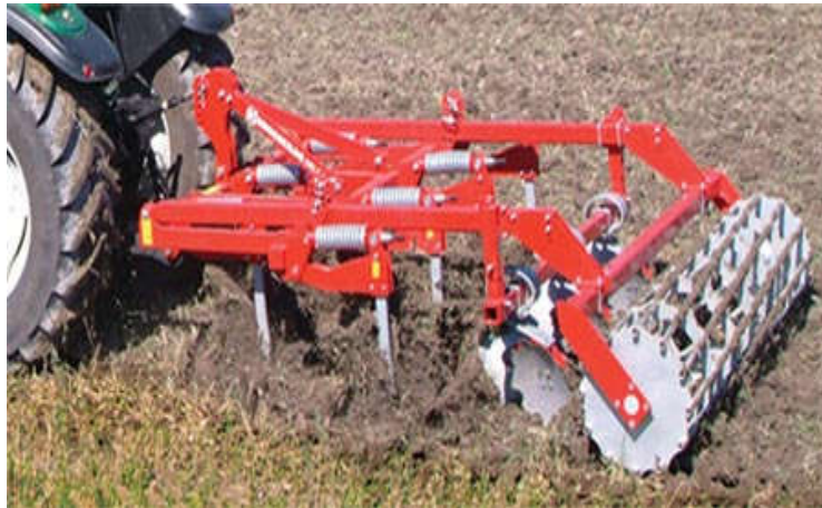
شکل ۱- استفاده از خاک‌ورز مرکب برای آماده‌سازی بستر بذر
