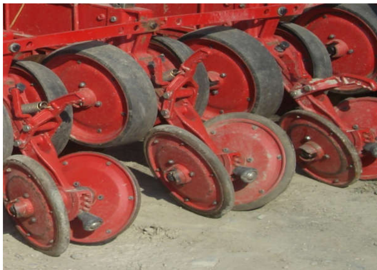
شکل ۴- چرخ های فشار مورب برای تثبیت بذر سویا در خاک
