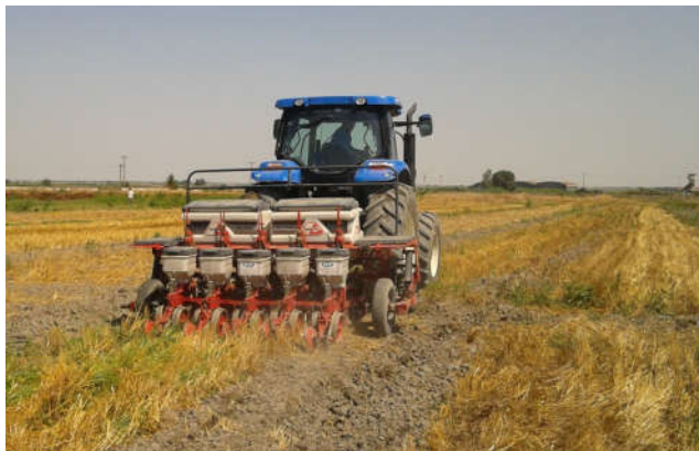
شکل ۲- کاشت سویا در روش بی خاک ورزی با کارنده کشت مستقیم
