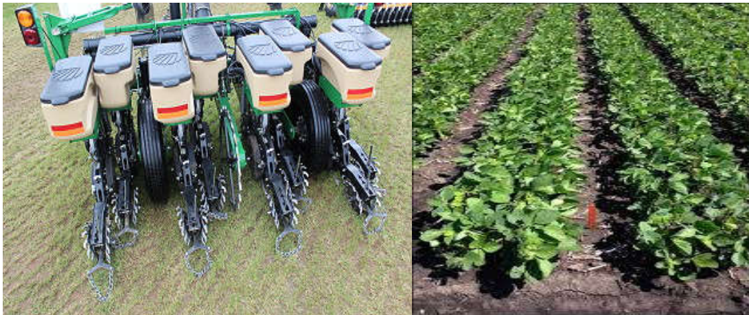
شکل ۵- روش قرار گرفتن واحدهای کارنده برای کاشت ردیف هایی با عرض کمتر در سویا
