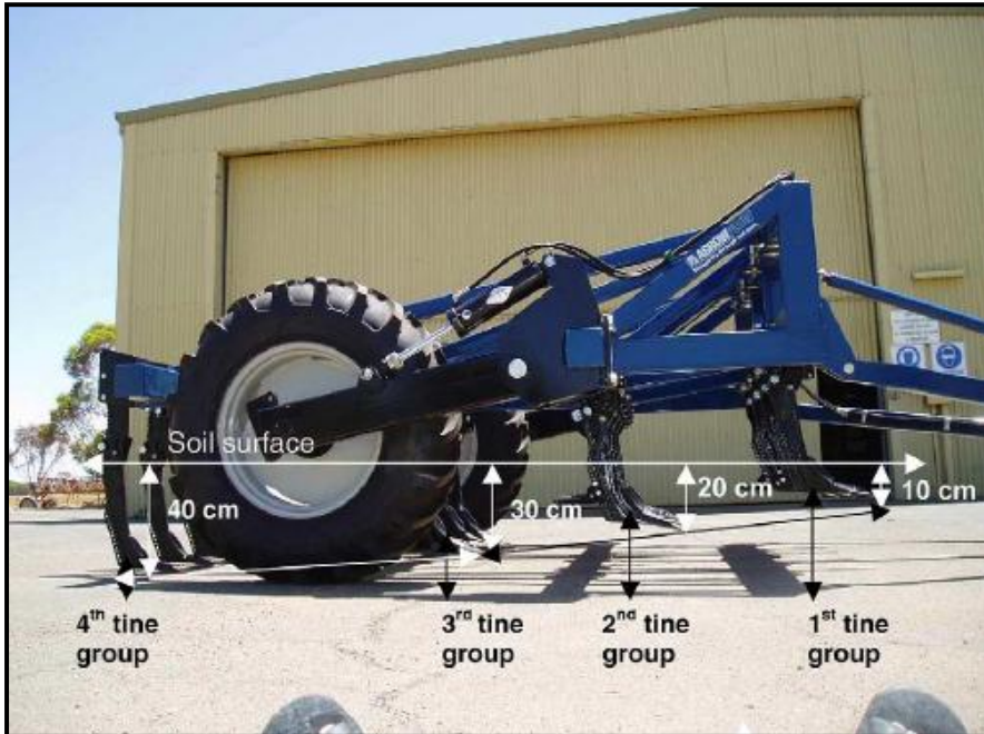
شکل ۶-۸- زیرشکن با تیغه بالهدار به همراه سه ردیف تیغه با عمق کارهای ۲۰، ۳۰ و ۱۰ سانتی‌متر در جلو (حمزه و اندرسون، ۲۰۰۵)
