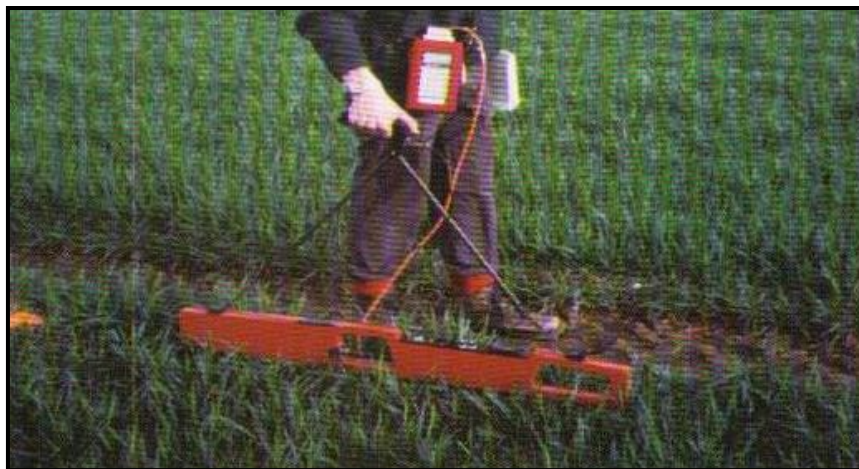
شکل ۵-۴- بررسی فشردگی خاک به وسیله دستگاه EM38 (شریفی و جوادی، ۱۳۸۶)
