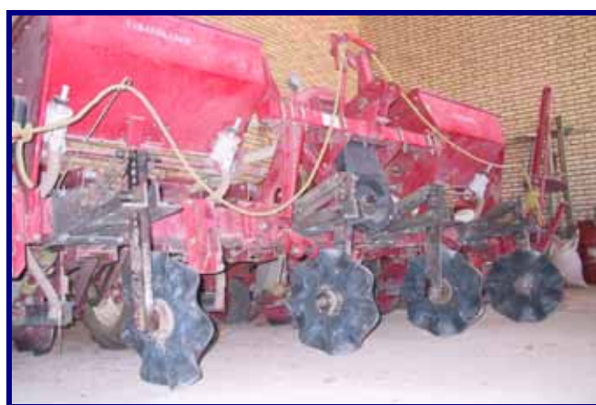
شکل ۳- نصب پیش‌برهای دیسکی مواج در جلو واحد های کاشت ردیف‌کارهای مرسوم
