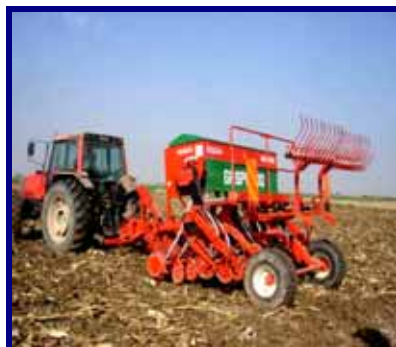
شکل ۱- ماشین کاشت مخصوص سیستم بی خاک‌ورزی برای غلات با شیار بازکن‌های دیسکی کنگره دار
