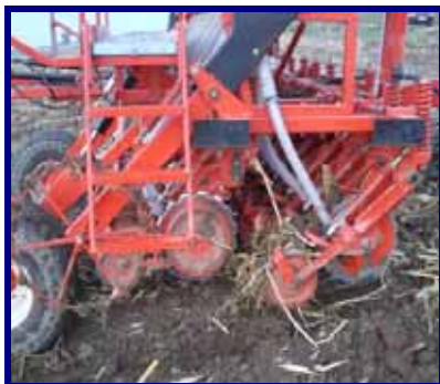
شکل ۱- ماشین کاشت مخصوص سیستم بی خاک‌ورزی برای غلات با شیار بازکن‌های دیسکی کنگره دار
