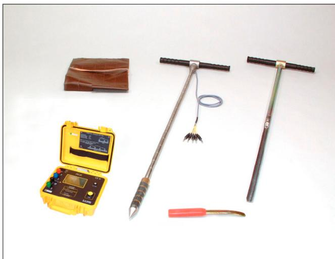
شکل ۱ - متعلقات یک دستگاه EC-probe استاندارد
