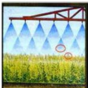
شکل ۱۱- سمپاشی نایکنواخت، به علت رعایت نشدن ارتفاع بوم و تغییر الگوی همپوشانی
