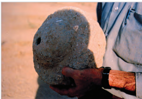
شکل ۱۸- تصویری از جمازه که برای بستن روزنه گیلون یا قعر به کار می رود.
