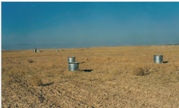
شکل ۳۶- اندازه‌گیری نفوذپذیری داخل بندسار در اطراف محل نمونه‌برداری از خاک
