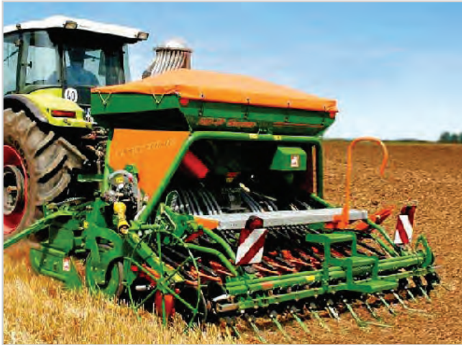
شکل ۱۷- کمینات، ترکیبی از ادوات خاک‌ورز و کاشت
