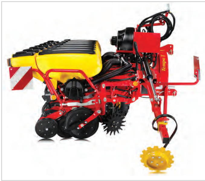
شکل ۱۱- کارنده‌هایی با ضمیمه‌های ردیف تمیز کن برای کشت برروی پشته
