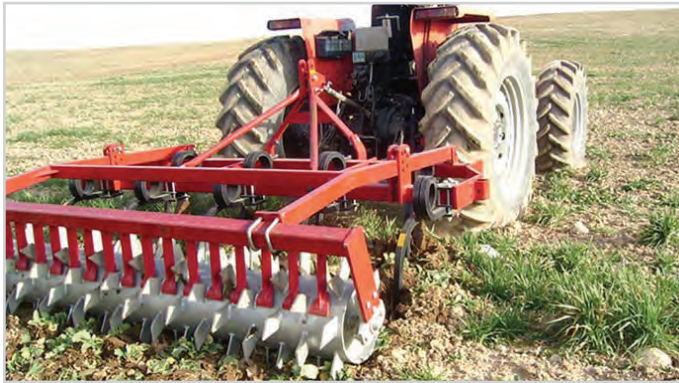
شکل ۸- خاک‌ورزهای مرکب با شاخه‌های نیمه عمیق برای کم‌خاک‌ورزی
