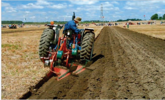
شکل ۳- شخم با گاو آهن بر گردان‌دار در خاک‌ورزی مرسوم
