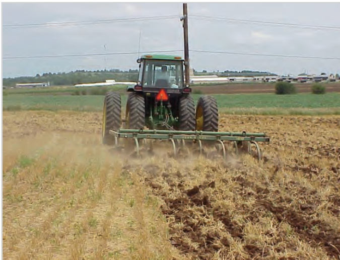
شکل ۱۰- خاک‌ورزی پوششی به وسیله گاو آهن‌های قلمی یا چیزل
