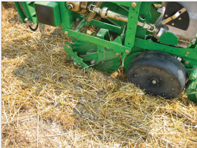
شکل ۱۵- شیار بازکن‌های مخصوص در کارنده‌های بی‌خاک‌ورزی برای استقرار بذر درون بقایای گیاهی
