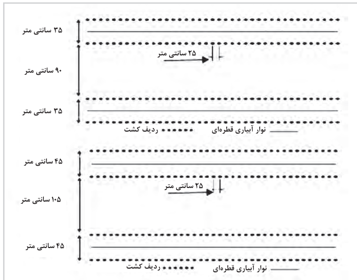
شکل ۳- وضعیت قرار گرفتن نوارهای آبیاری قطره‌ای و ردیف‌های کاشت غده‌های سیب‌زمینی در دو آرایش کاشت
