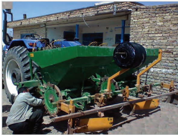
شکل ۵- دستگاه غده کار چهار ردیفه سیب‌زمینی همراه با نصب نوار آبیاری قطره‌ای
