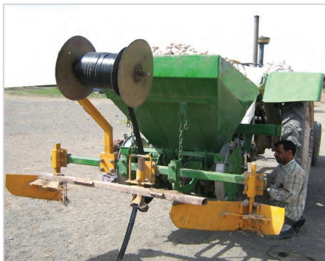
شکل ۴- دستگاه غده‌کار (دو ردیفه) سیب‌زمینی همراه با نصب نوار آبیاری قطره‌ای
