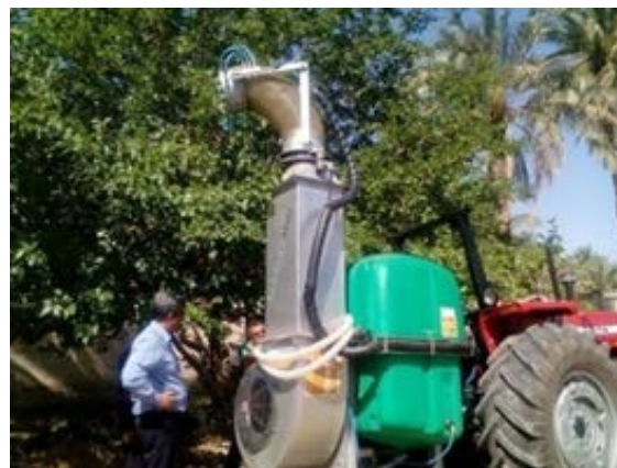
شکل ۲۹- سمپاش پشت تراکتوری توربینی، بهسازی شده برای باغات خرما
