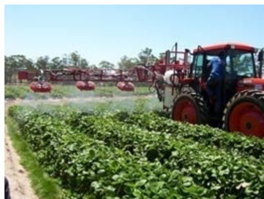
شکل ۴۳- سمپاش توربینی ردیفی با توربین های شعاعی
