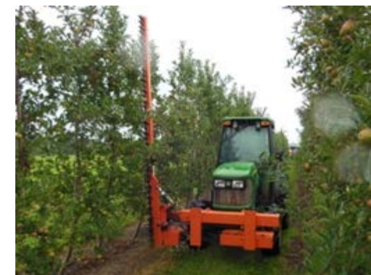
شکل ۳۶- سمپاش توربینی با نازل های دارای آرایه خطی، با قابلیت تغییر زاویه آرایه نازل ها
