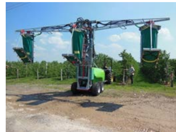
شکل ۳۵- سمپاش توربینی با نازل های دارای آرایه خطی با قابلیت تغییر ارتفاع نازل ها
