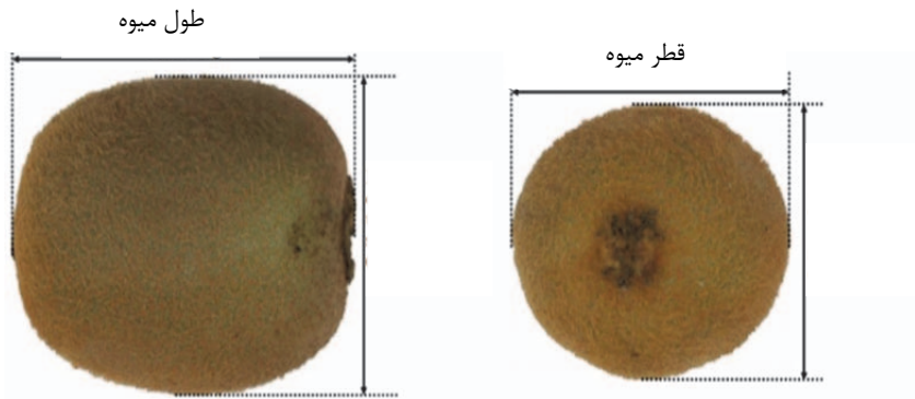
شکل ۸- اندازه‌گیری نسبت طول به قطر میوه
