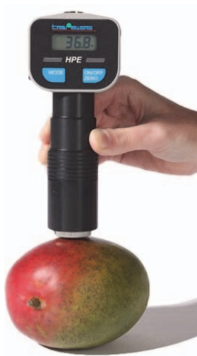
شکل ۴- نفوذسنج قابل حمل
