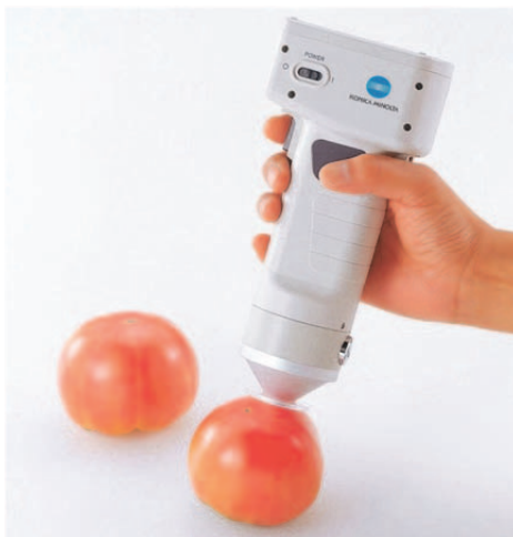
شکل ۱- مدلی از رنگ‌سنج و نحوه اندازه‌گیری مؤلفه‌های مربوط به رنگ توسط آن
