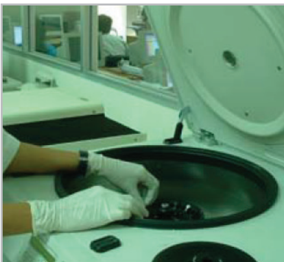
۶. سوسپانسیون حاصله در ۴۰۰۰ گ به‌مدت ۵ دقیقه سانتریفیوژ شود.
