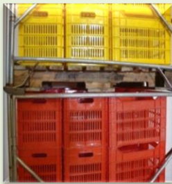
شکل ۲۴- فاصله مناسب بین جعبه‌ها جهت گردش هوا
