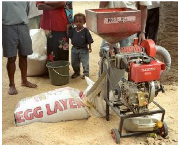
شکل ۵: آسیاب کردن سبوس برنج و الک کردن آن
