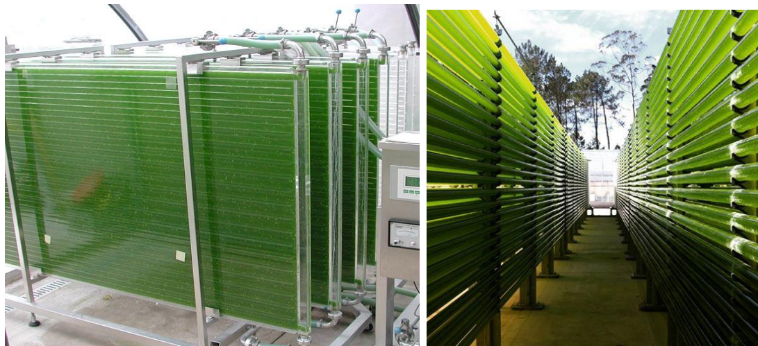
شکل ۱۰- کشت مداوم ریز جلبکها با استفاده از فتوبیورآکتورها
