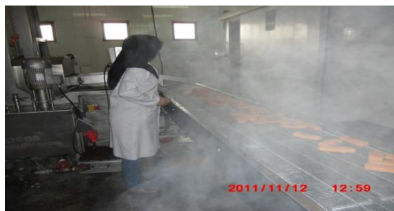
شکل ۱۳. مراحل مختلف سرخ کردن برگرها و اندازه گیری دمای مرکز محصول
