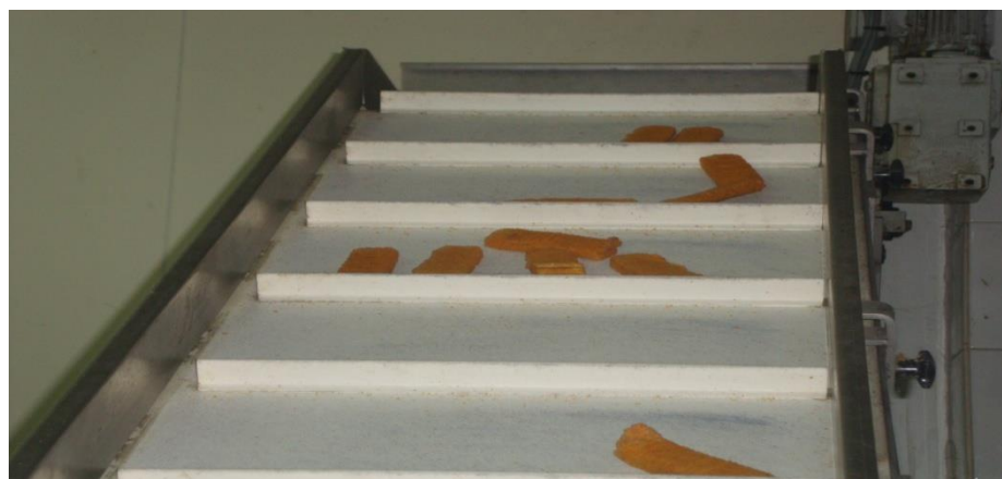
شکل ۱۴ انتقال برگرها به دستگاه فریزر ماریچی بمنظور انجماد
