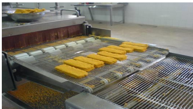
شکل ۱۲. پوشش دهی برگرها با پودر سوخاری
