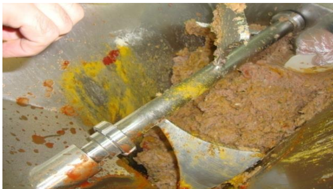
۸. شکل میکس و ترکیب گوشت ماهی با مواد پرکننده و تولید خمیر اولیه
