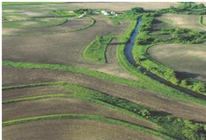
شکل ۴-۱۲ بافرهای حفاظتی برای جلوگیری از ورود آلاینده‌ها به رودخانه
