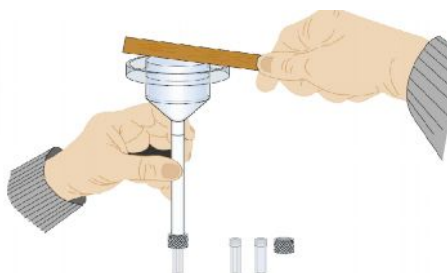
شکل ۶-۷ ویسکومتر نوع SMR (آلفا لاوال/ تتراپک، ۱۹۹۵)
