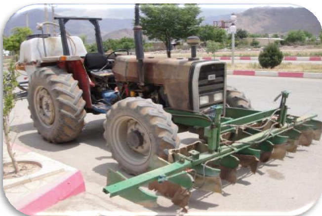
شکل 2- دستگاه طراحی شده برای کنترل علف‌های هرز بین ردیف‌های کشت نخود به صورت هدایت شده با علف‌کش‌های عمومی تماسی
