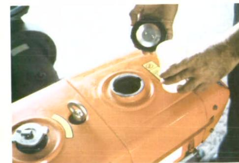
در فشاری رادیاتور را برداشته و مخزن را با آب تمیز (عاری از شن یا دیگر ناخالصی ها) پر نمایید.
