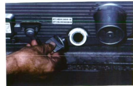
در پوش صافی هوا را برداشته و مخزن را تا خط تراز با روغن تازه موتور پر نمایید.
