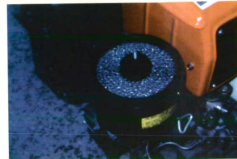
باک سوخت را با گازوئیل و از طریق صافی سوخت پر نمایید. مصرف سوخت آلوده به گرد و غبار یا دیگر ناخالصی ها عمر موتور را کاهش داده، به پمپ انژکتور نیز صدمه می زند.
