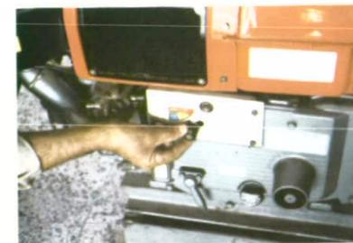
برای سریع روشن شدن موتور در هوای سرد، دکمه Injection Button را فشار دهید. در صورتی که هوا گرم یا موتور گرم باشد نیازی به استفاده از این دکمه نیست.
