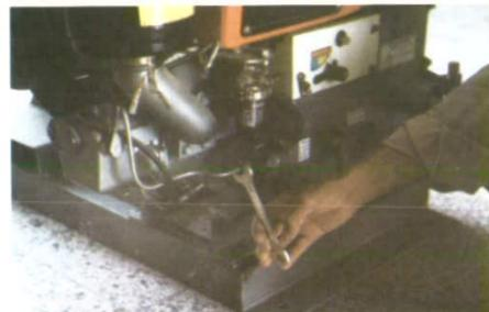
فلائویل را بچرخانید تا بیشترین تراکم (نقطه مرگ بلا) از طریق اهرم پمپ دستی احساس شود. در آن نقطه، اهرم پمپ دستی را حدود ۱۰ مرتبه بزنید تا اینکه صدای تزریق سوخت شنیده شود. در این حالت موتور برای روشن شدن آماده است.
