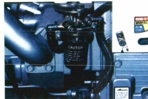
دو عدد پیچ هواگیری روی پمپ انژکتور را شل کنید و پس از خارج شدن هوا از سوخت، دو مرتبه آنها را سفت نمایید.
