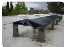
شکل ۴: خشک کن آفتابی تونلی
