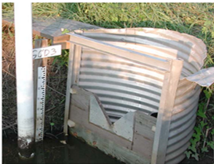
شکل ۳- کنترل سطح ایستابی در زهکش های روباز
