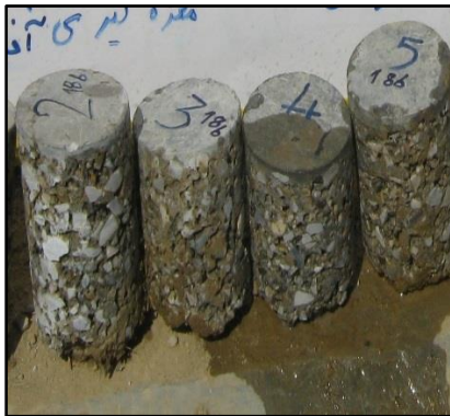
شکل ۴: کیفیت ظاهری بتن بادوام (سمت راست) نسبت به بتن معمولی (سمت چپ) در پوشش کانال‌های آبیاری
