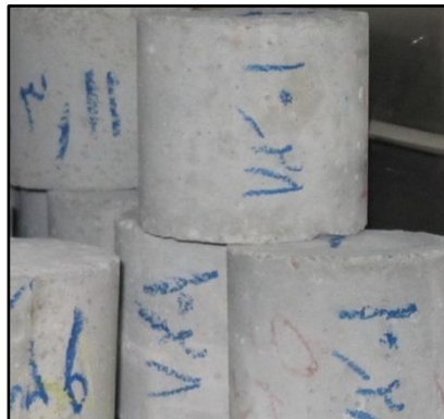
شکل ۴: کیفیت ظاهری بتن بادوام (سمت راست) نسبت به بتن معمولی (سمت چپ) در پوشش کانال‌های آبیاری
