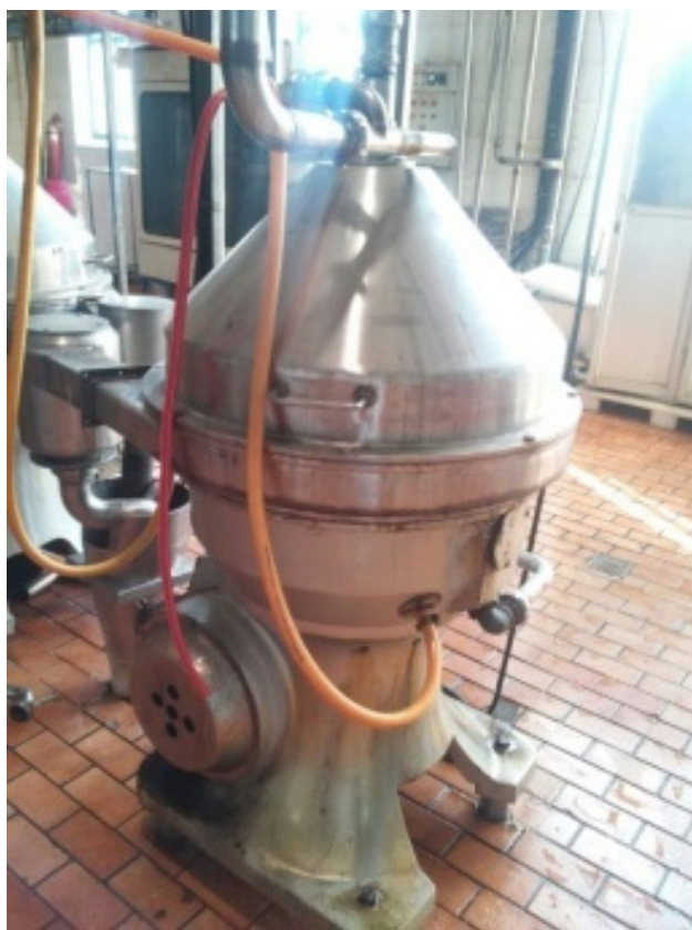
شکل ۱۰- کلاریفایر برای صاف کردن شیر
