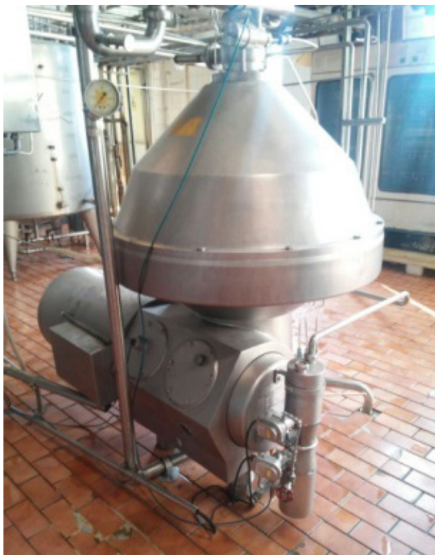
شکل ۱۲- باکتوفوژ برای جدا کردن باکتری ها
