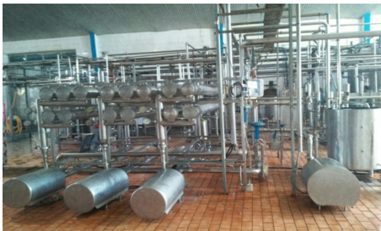
شکل ۲۰- تجهیزات فرایالایش جهت تغلیظ شیر پنیرسازی قبل از زدن رنت
