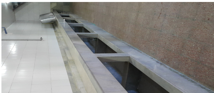
شکل ۲۶- حوضچه های خواباندن قالب های پنیر در آب نمک
