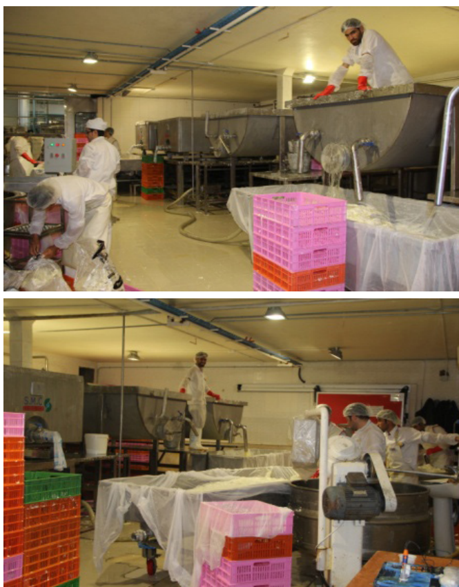
شکل ۲۲- آبگیری دلمه توسط صاف کردن با توری
