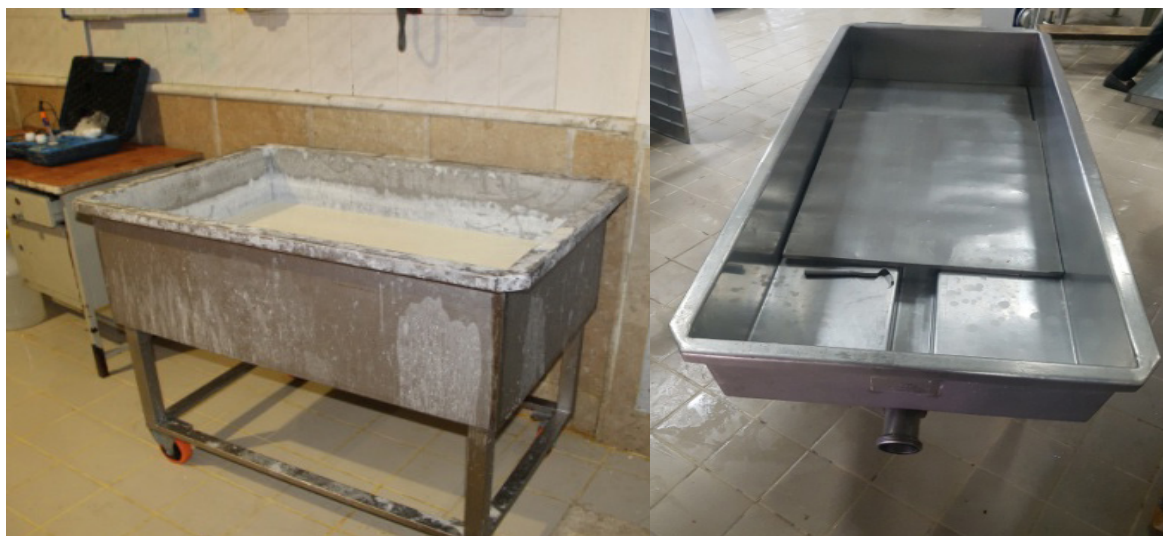
شکل ۱۸- وت پنیر (شکل بالا) و تشکیل دلمه از شیر درون وت (شکل پایین)
