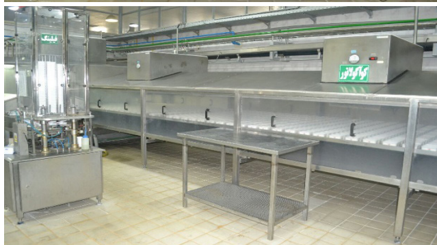
شکل ۲۱- تونل انعقاد برای انعقاد شیر تغلیظ شده در تولید پنیر فرایالایش
