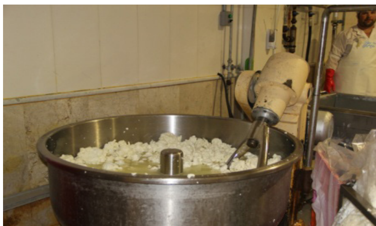
شکل ۲۳- عمل آوری دلمه پنیر (شکل بالا) و دیگ پخت دلمه (شکل پایینی)
