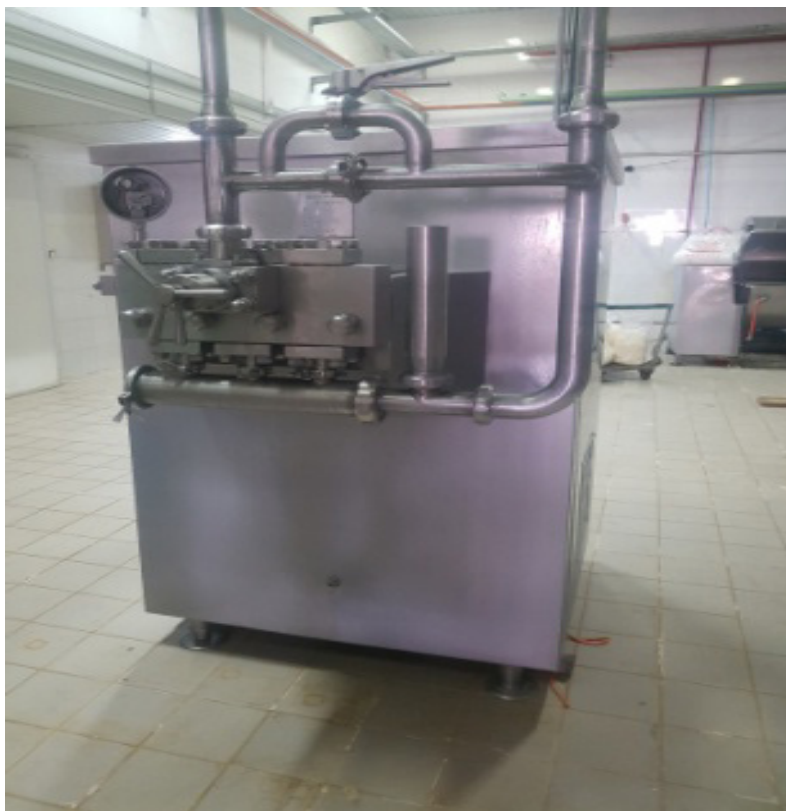
شکل ۱۴- دستگاه هموژنایزر برای ریزکردن ذرات چربی
