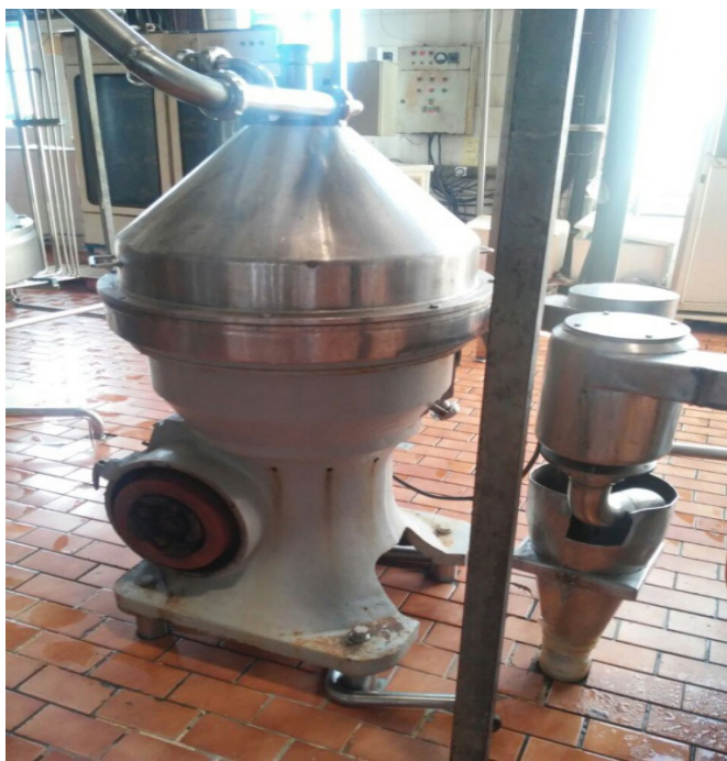
شکل ۳- سپراتور برای جداکردن چربی از شیر
