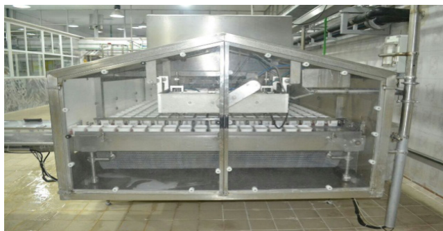
شکل ۲۰- تجهیزات فرایالایش جهت تغلیظ شیر پنیرسازی قبل از زدن رنت
