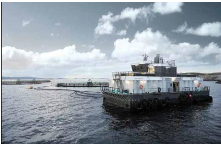
عکس ۱۱۴. سیستم تغذیه متمرکز روی یک کرجی ویژه
