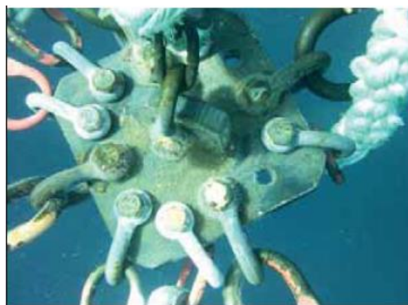
عکس ۱۳. صفحه کنکتور دوازده حفره که چهار حفره آن برای آن برای اتصال خطوط مهارسازی و هشت حفره برای اتصال زنجیر مهارسازی قفس است
