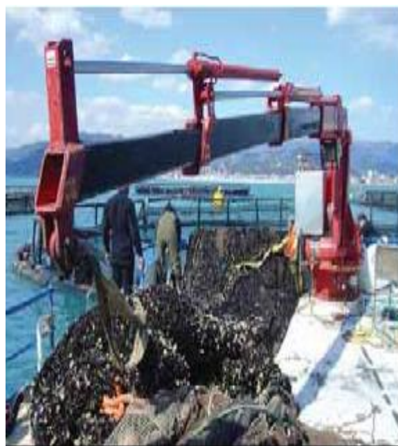
عکس ۸۸. یک تور کثیف روی عرشه قایق کاری. توجه کنید که اتصال مورد استفاده برای بالا بردن تور هنوز به قلاب جرثقیل متصل است.
