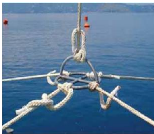
عکس ۲۱. حلقه فولادی متصل به خطوط شبکه و زنجیرهای مهار قفس
