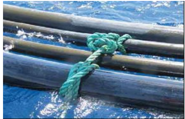
شکل ۵۱. یک گره متناوب برای ایمن سازی خط زنجیر زنجیر مهار روی یک طوقه - یک گره دوخت روی بیرونی ترین لوله، با سر آزاد باقیمانده که روی لوله پیاده‌رو ثابت شده. گره ترجیحی برای ایمن سازی زنجیر مهار در شکل ۳۳ نشان داده شد.
