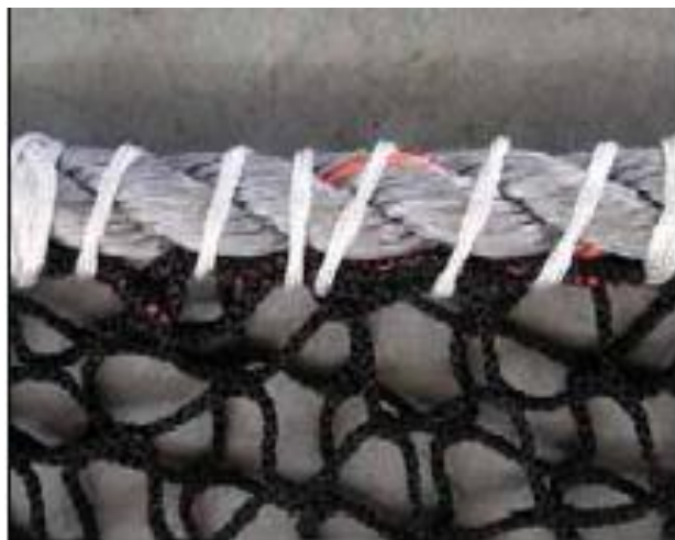
عکس ۵۷. دوخت طناب به تور با چرخ خیاطی
