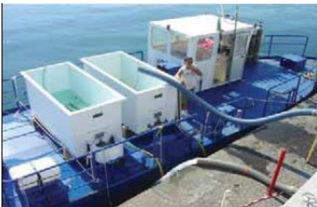
عکس ۱۰۰. یک قایق کاری کوچک مجهز به دو مخزن، هر یک با حجم 2\text{ m}^3 .
