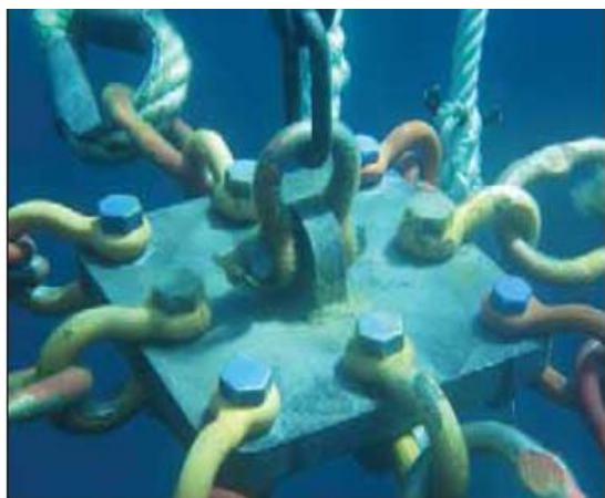
عکس ۱۴. کنکتور هشت حفره که چهار حفره آن برای خطوط مهارسازی اصلی و چهار حفره دیگر برای اتصال زنجیرهای مهارسازی است
