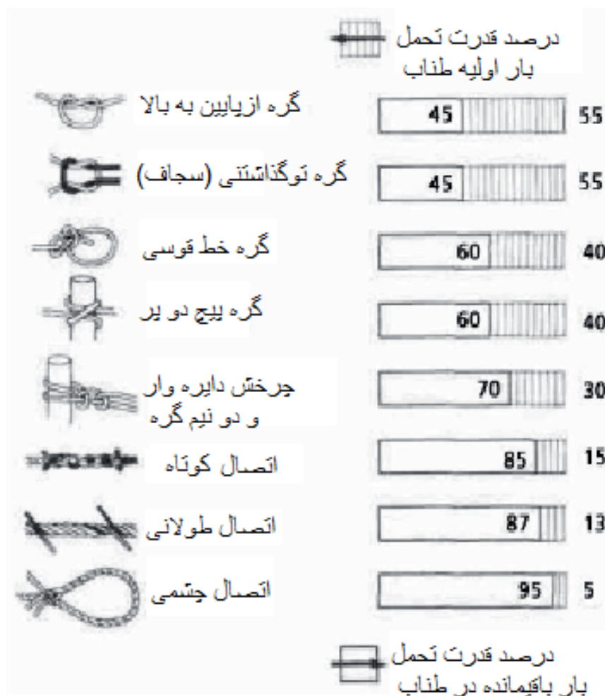
شکل ۴۰. عدم مقاومت در طناب‌های گره خورده
