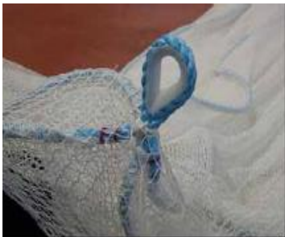
عکس ۶۴. حلقه طناب خط آب با لوله حفاظ انعطاف پذیر عکس ۶۵. حلقه طناب سطح آب با چشمی پلاستیکی
