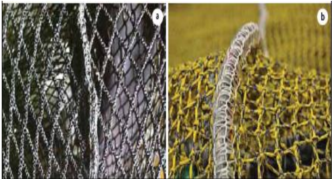
عکس ۵۵. بخیه‌ها در تورهای قفس (a) تور به تور (b) تور به طناب
