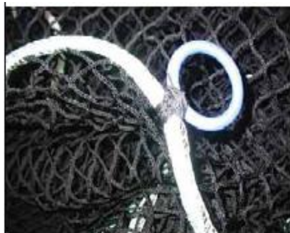
عکس ۶۸. حلقه پلاستیکی روی طناب عمودی
