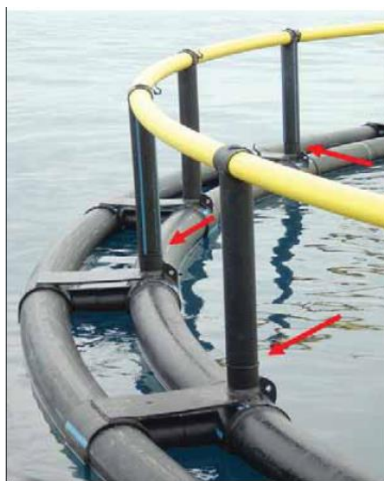
عکس ۲۴. براکت‌های HDPE ساخته شده با لوله‌های HDPE که روی یک قفس تعبیه شدند. توجه کنید جوش‌های لولا روی پایه (پیکان قرمز)، استحکام کمتری دارند.
