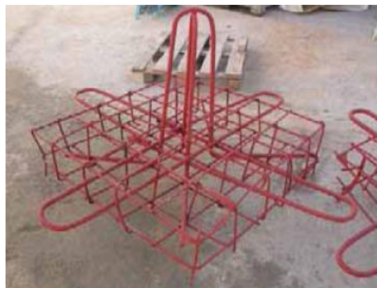
عکس ۴. قاب آهنی مورد استفاده برای ساخت بلوک بتنی در محل
