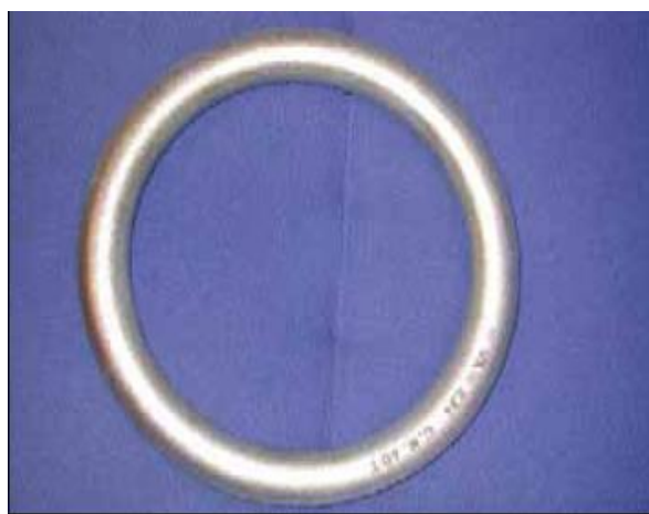
عکس ۱۵. یک حلقه فولادی واقع در کنار صفحه کنکتور مورد استفاده در شبکه مهاربندی
