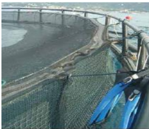
عکس ۷۲. تور بالایی قفس که با یک زیپ در یک قفس شناور ثابت شده است
