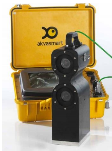
شکل ۳۰: سیستم اندازه‌گیری طول و قد ماهیان با دقت بالا
