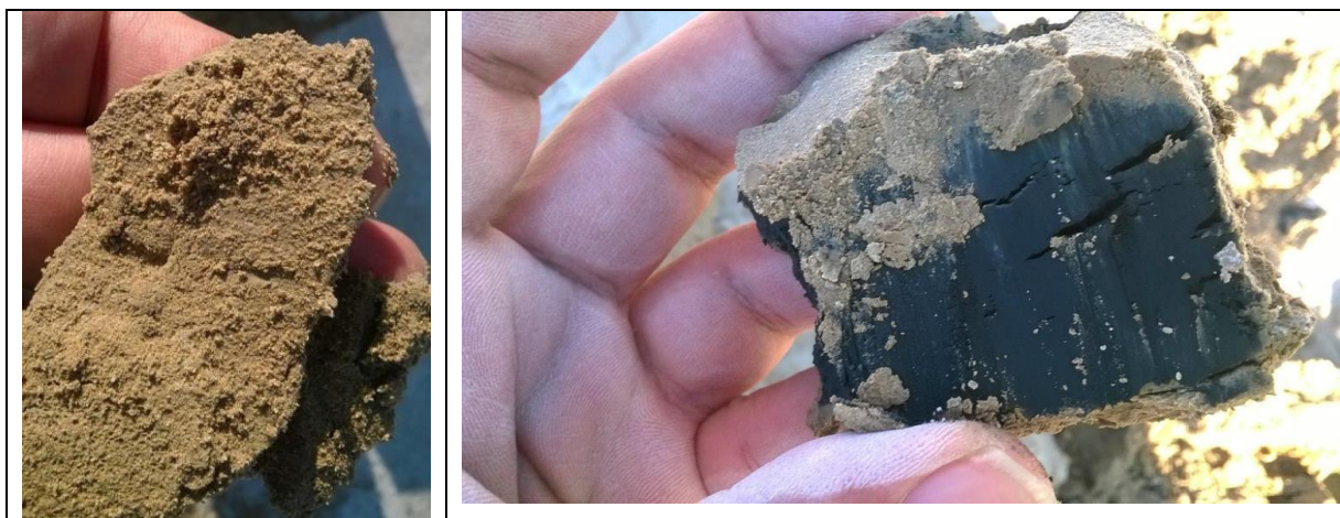
شکل ۶: بررسی خاک سیاه کف استخر برای ارزیابی برداشت (سمت راست) یا عدم نیاز به برداشت (سمت چپ)
