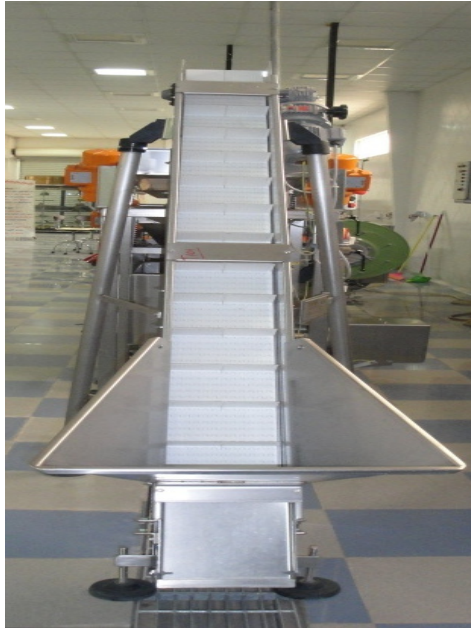
شکل ۷- نقاله انتقال خرما با شیب مناسب
