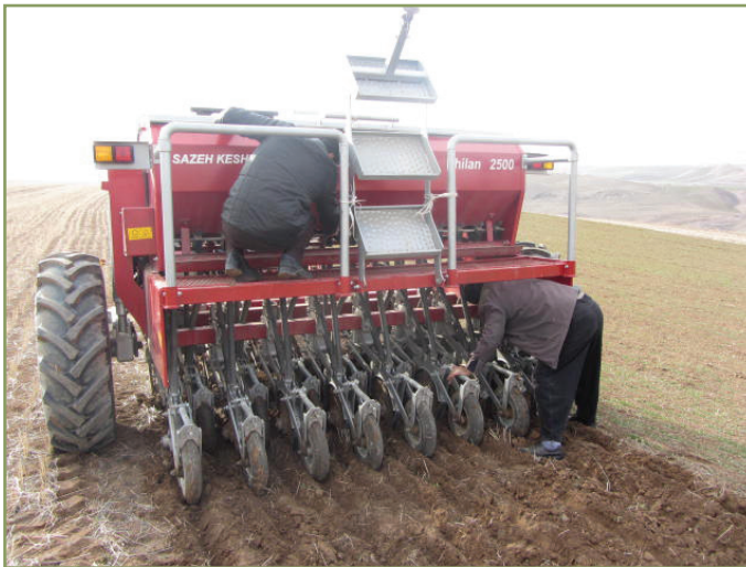
شکل ۶- ماشین کشت مستقیم مورد استفاده در کشاورزی حفاظتی
