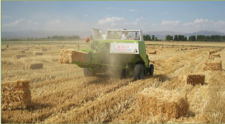
شکل ۳- جمع‌آوری بقایای گیاهی به‌وسیله بسته‌بندکن
