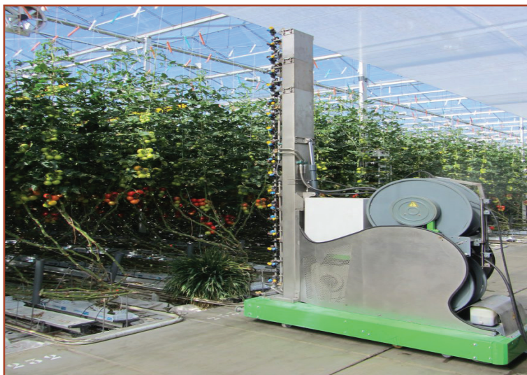
شکل ۳۵- سیستم سم‌پاشی هوشمند گلخانه‌ای (ماشین سم‌پاش بر روی ریل‌های تعبیه‌شده در گلخانه حرکت می‌کند و به‌صورت خودکار عملیات سم‌پاشی را انجام می‌دهد)
