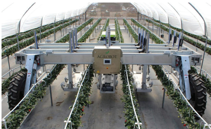
شکل ۳۷- یک ربات برداشت‌کننده توت‌فرنگی گلخانه‌ای
