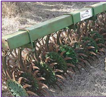
وجین کن (کولتیواتور دوار) جهت وجین علف‌های هرز مزارع زعفران در کاشت‌های ردیفی (برگرفته از سعیدی‌راد و همکاران، ۱۳۹۶)
